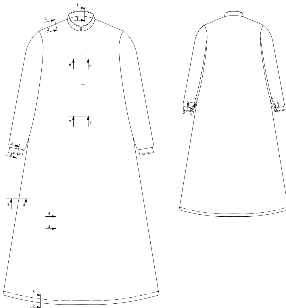
Рисунок 4.6 – Технический эскиз подрясника
